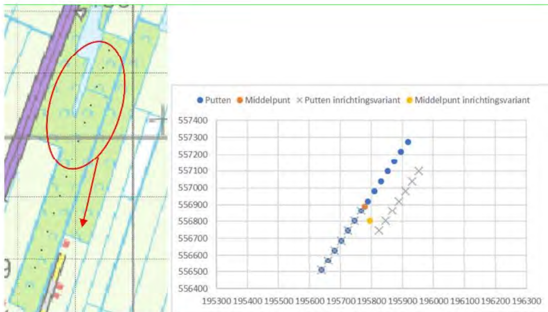
Figuur 3.14 Verschuiving zwaartepunt door putten zo zuidelijk mogelijk op de winlocatie te plaatsen
